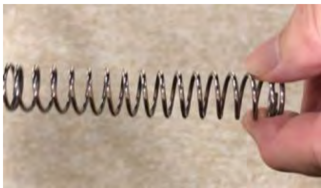
バネへのNi-W合金めっき(10 \mu m厚)
