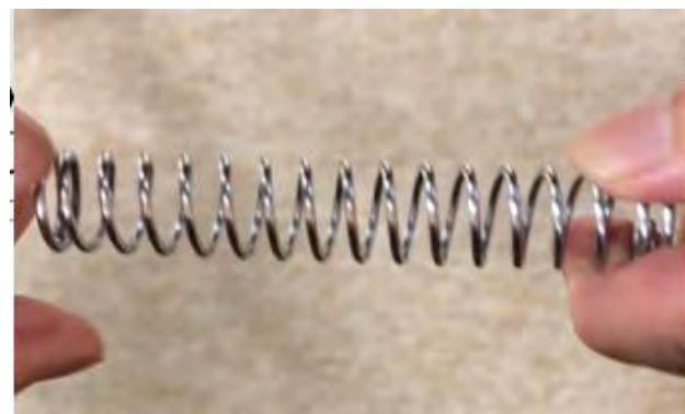
バネへの硬質Crめっき(10 \mu m厚)
